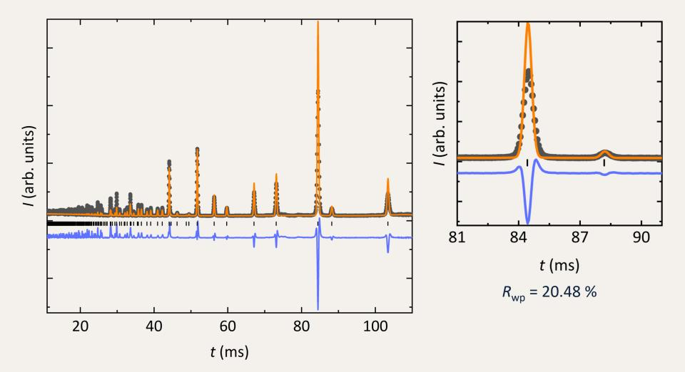
Step 3: Refine the unit cell parameters
